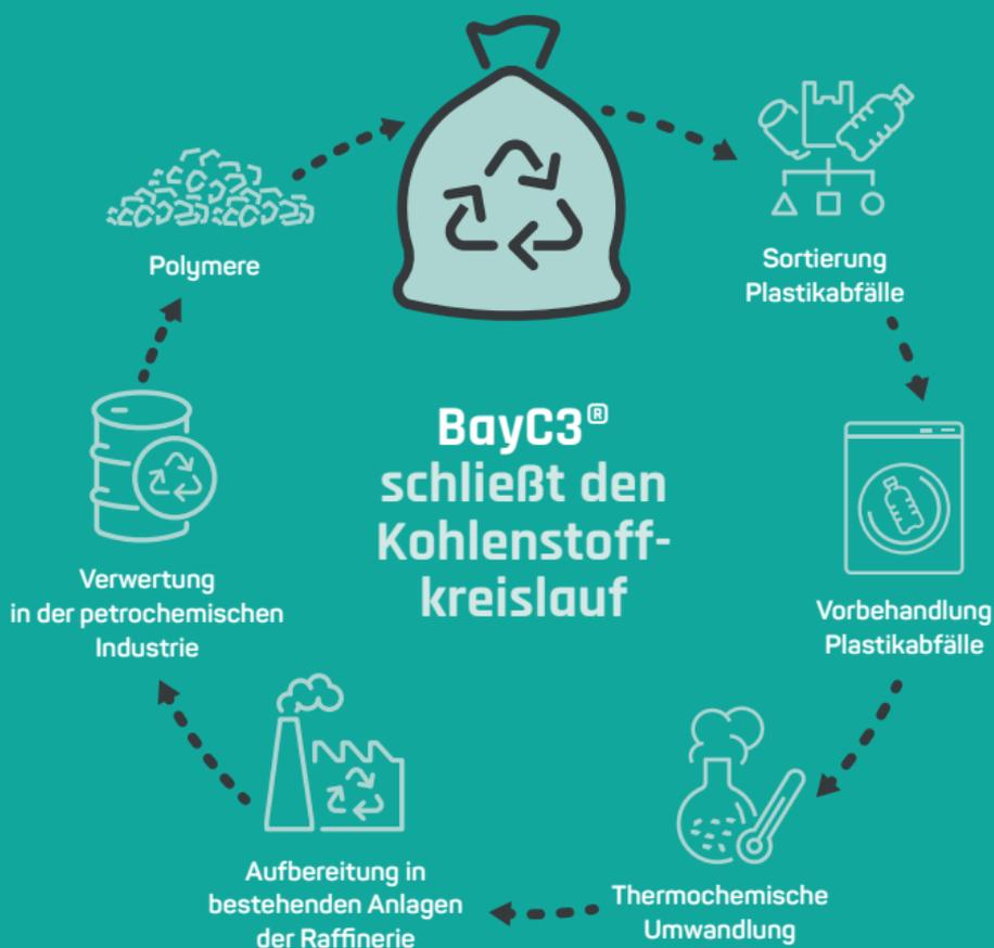
**Das chemische Recycling-Verfahren BayC3<sup>®</sup> ergänzt das herkömmliche mechanische Kunststoff-Recycling und ermöglicht damit eine insgesamt höhere Recyclingquote.**
